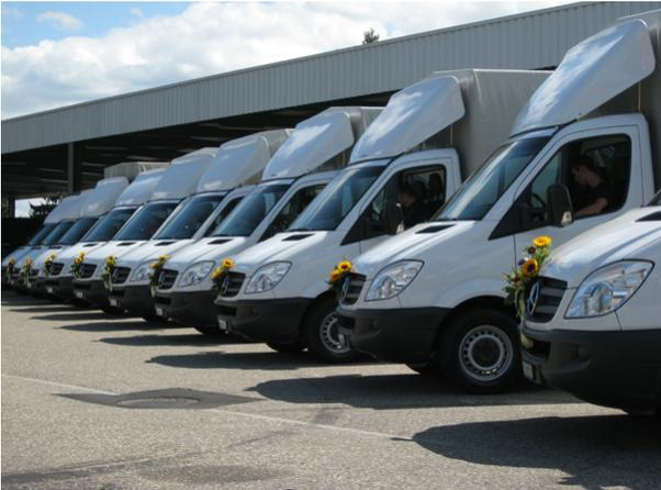
7 neue Sprinter 318 CDI mit Brücke und Hebebühne
